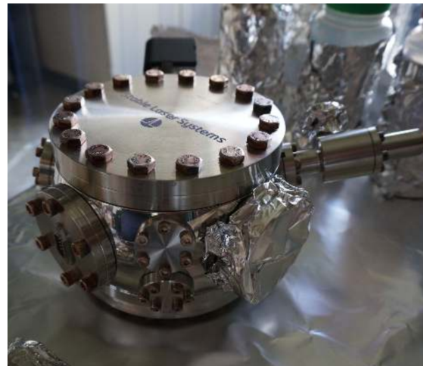
(b) Verschlossene Vakuumkammer. Am linken Flansch ist der D-Sub-9-Stecker erkennbar über den die Peltierelemente sowie die Thermistoren angeschlossen werden. Oben im Hintergrund ist als schwarze Kiste die Ionen-Getter-Pumpe erkennbar. Rechts im Bild ist das Ventil zu sehen über das die Kammer ausgepumpt werden kann.
